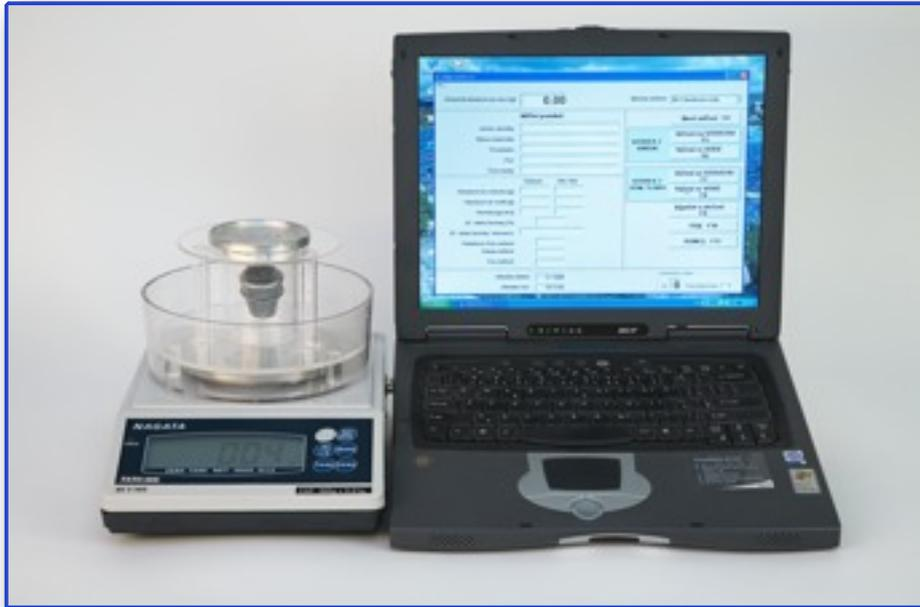
**Elektronische Waage und mitgelieferte Software für Auswertung des Dichteindex.**
